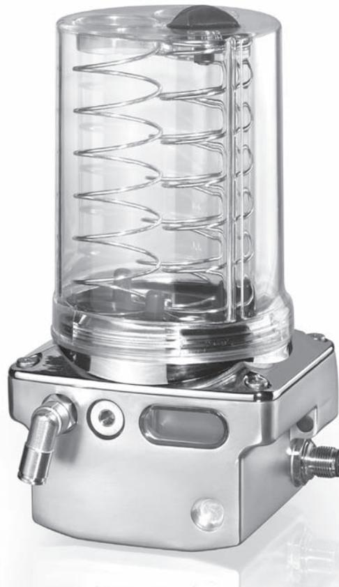
**FlexxPump 401** alimentatore di rilubrificazione per grasso a comando temporizzato a 24V DC; per cartuccia da 400 cm<sup>3</sup>; coperchio dell'involucro in metallo; (nella figura: 135-140-101)
